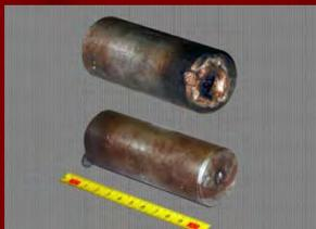
Стальной образец толщиной 15 см, «просверленный» лучом твердотельного лазера
